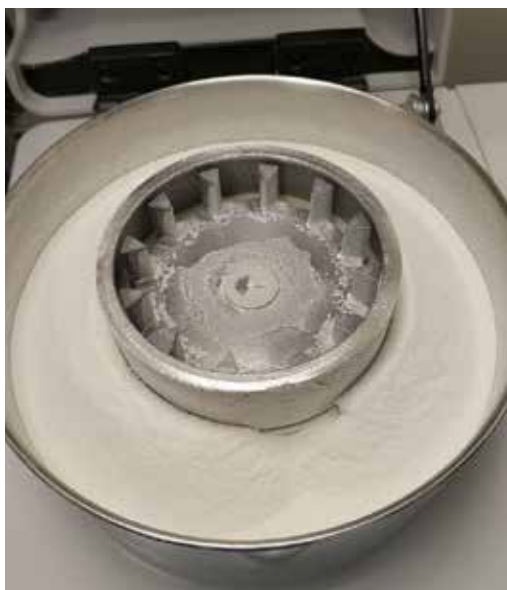
Рис. 1. Фото ультрацентрифужного млина Retsch ZM 200
